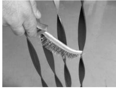
Figura 57 - Limpieza de los canales de paso de aire y turbuladores
