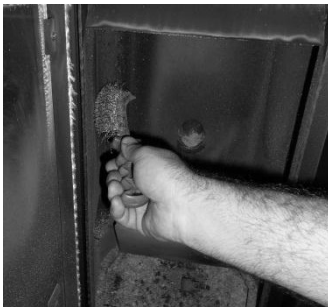
Figura 50 - Limpieza del interior de la estufa de agua
