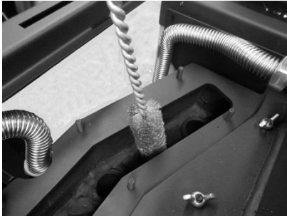
Figura 57 - Limpieza de los canales de paso de aire y turbuladores
