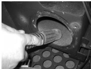
Figura 59 - Aspirar la zona de paso del aire
