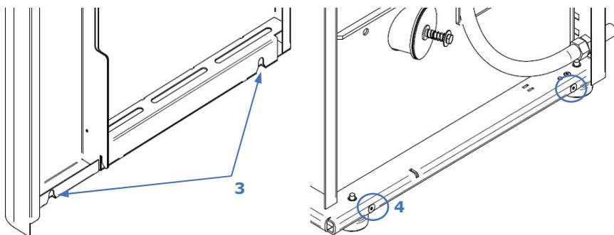
**Figura 31 – Colocação das envoltentes Hidro 17 e Hidro 23**
