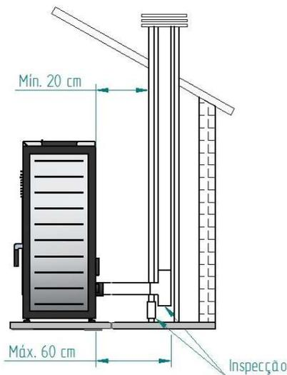
**Figura 13 – Vista lateral da instalação com chaminé, com exemplo do ponto de inspeção**
