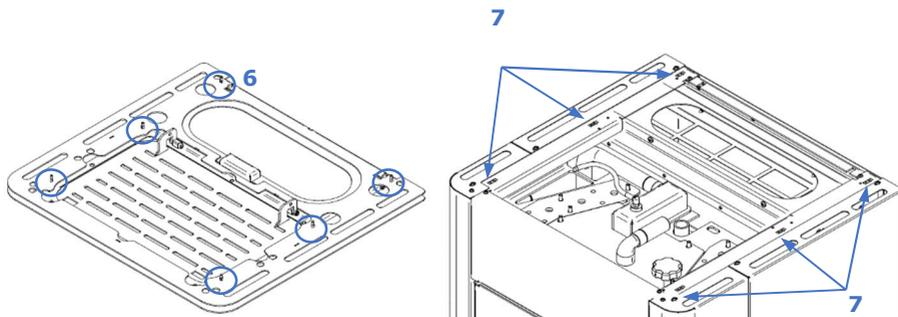
**Figura 34 – Colocação do tampo superior Hidro 17 e Hidro 23**
