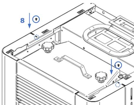
**Figura 24 – Colocação das envoltentes Hidro 12**
