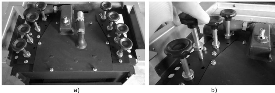
**Figura 50 - Limpeza dos turbuladores**
