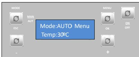
**Modo "auto":** neste modo a máquina vai ligar na potência máxima e permanecer nela até atingir uma temperatura 1°C acima da temperatura seleccionada (temperatura de set point). Quando atinge essa temperatura passa a funcionar na potência mínima. É possível variar a temperatura de set point, de 5 a 40 °C, carregando nas teclas "-" e "+".
