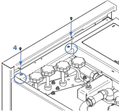
**Figura 37 – Colocação das envoltentes Hidro 17 e Hidro 23**
