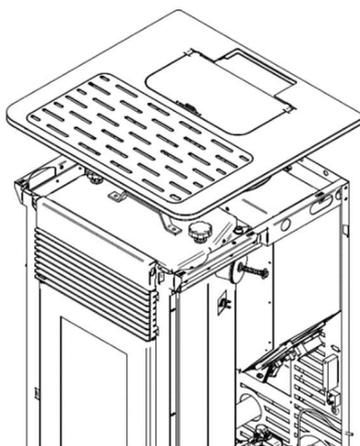
**Figura 25 – Colocação do tampo superior Hidro 12**
