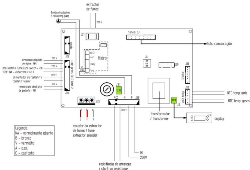
Figura 69 - Esquema eléctrico Hidro 12
