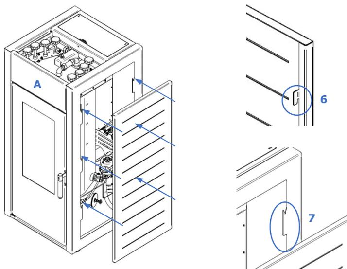
**Figura 39 – Colocação das envolventes Hidro 17 e Hidro 23**
