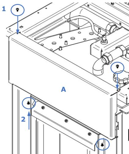
**Figura 30 – Colocação da capa frontal Hidro 17 e Hidro 23**
