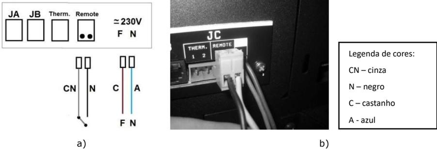
**Figura 44 - Ligação do comando remoto sem fios**
