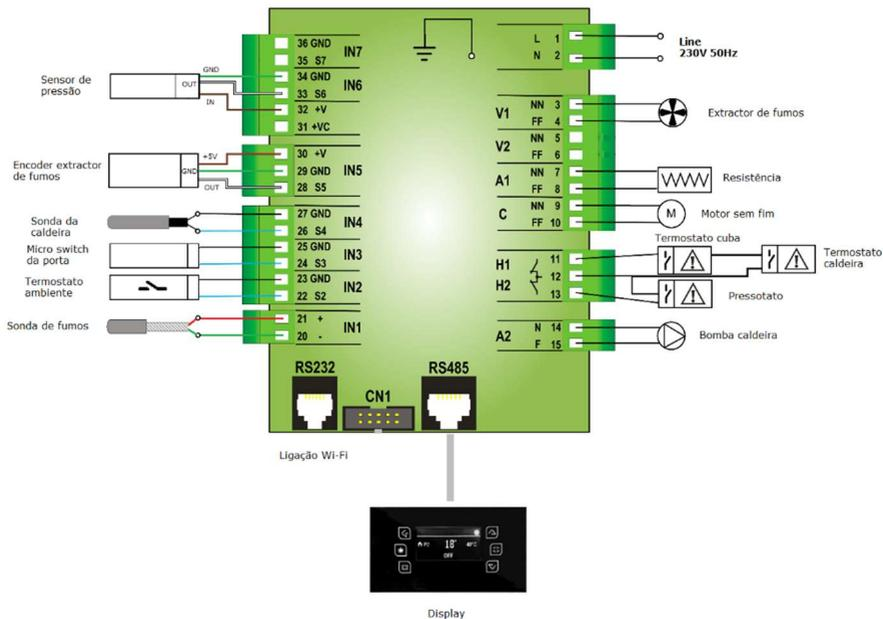
**Figura 71 - Esquema eléctrico (eletrónica Columbus)**
