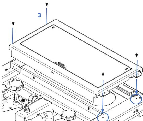
**Figura 36 – Colocação do tampo superior Hidro 17 e Hidro 23**
