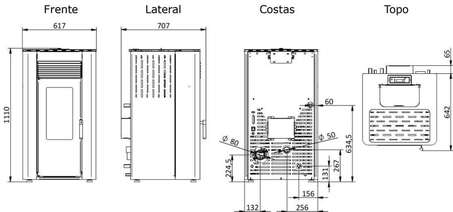
**Figura 2 - Dimensões da salamandra a pellets Hidro 12**
