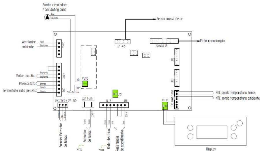
Figura 70 - Esquema eléctrico Hidro 17 e 23
