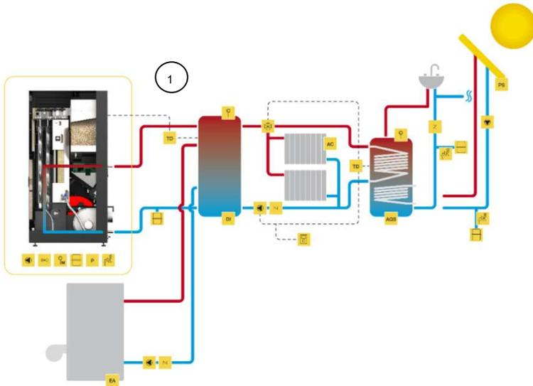
**Figura 66 - Ligação a radiadores de aquecimento central, conjugado com outra caldeira de apoio e águas sanitárias combinado com painel solar**
