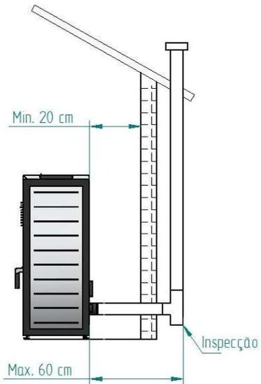
**Figura 11 – Vista lateral da instalação sem chaminé, com exemplo do ponto de inspeção**
