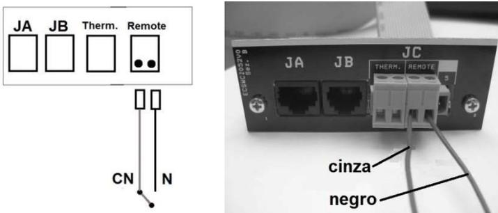
**Figura 45 - Ligações do comando externo com fios**
