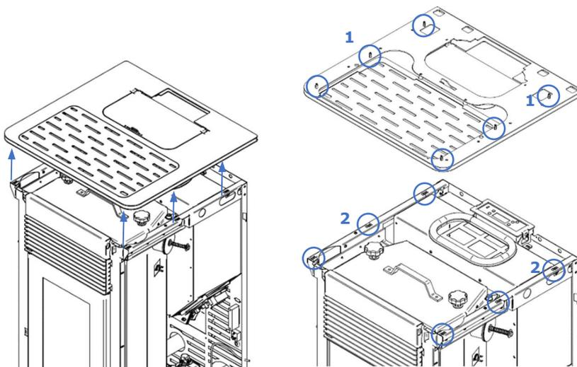
**Figura 20 – Remoção do tampo superior Hidro 12**
