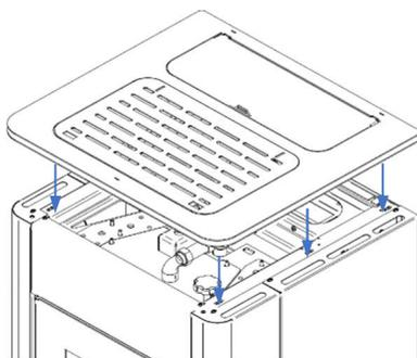
**Figura 33 – Colocação do tampo superior Hidro 17 e Hidro 23**
