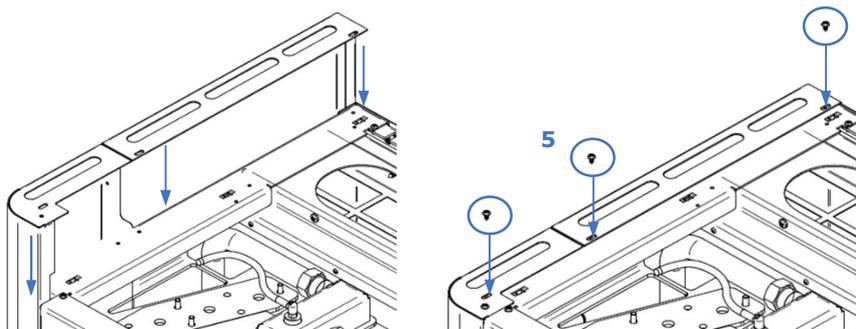
**Figura 32 – Colocação das envolventes Hidro 17 e Hidro 23**
