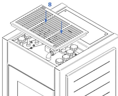
**Figura 40 – Colocação das envolventes Hidro 17 e Hidro 23**
