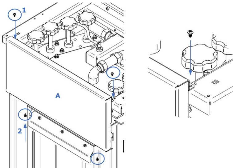
**Figura 35 – Colocação da capa frontal Hidro 17 e Hidro 23**
