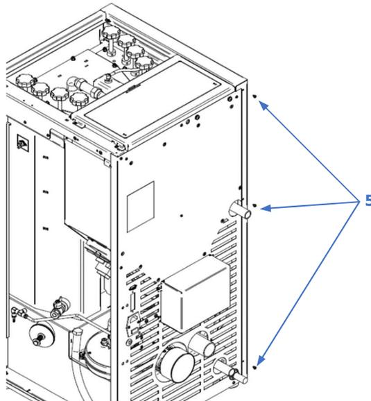
**Figura 38 – Colocação das envoltentes Hidro 17 e Hidro 23**
