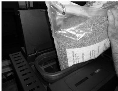
**Figure 42 – Réapprovisionnement du réservoir à granulés**
