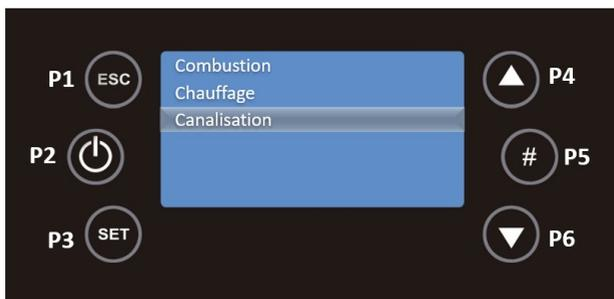
Ce sous-menu vous permet de modifier la valeur de la puissance du ventilateur de gaine. Il ne s'affiche que si vous sélectionnez un système de chauffage qui comprend un deuxième ventilateur de chauffage. Avec les touches P4 et P6, il peut être réglé en mode automatique ou manuel : dans le second cas, l'utilisateur sélectionne la puissance de 0 à 5.
