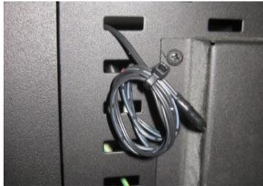
**Figure 15 - Sonde de température ambiante**
