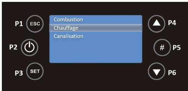
Avec les touches P4 et P6, vous pouvez modifier la puissance de combustion du système. Ce sous-menu permet de modifier la puissance de ventilation du système. Il peut être réglé en mode automatique ou manuel : dans le second cas, l'utilisateur sélectionne la puissance de 0 à 5.
