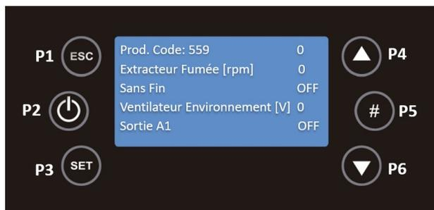
Il est possible d'interroger la température de la fumée, la température ambiante et l'état des entrées. Si l'état de l'entrée est ouvert (0) ou fermé (1).
