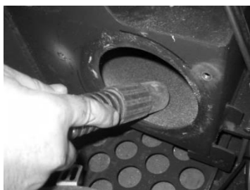
Figura 59 - Aspirar la zona de paso del aire
