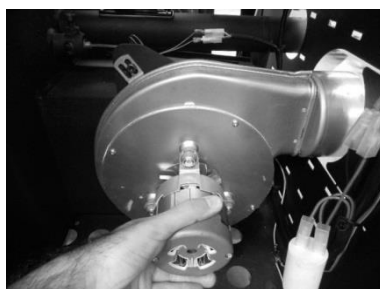
Figura 58 - a) Retirar los tornillos; b) Retirar el extractor
