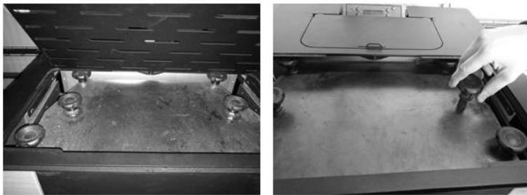
Figura 46 - Limpieza de los turbuladores
