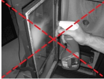
Figura 60 - Limpieza incorrecta del vidrio
