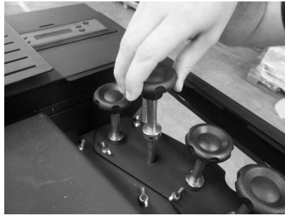
Figura 49 - Limpieza de los turbuladores
