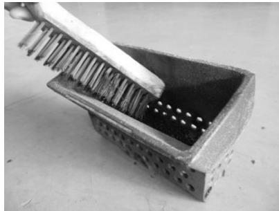
Figura 52 - Limpieza del cestillo de quema
