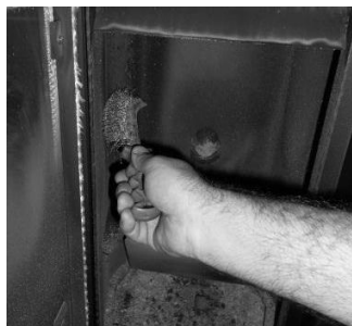
Figura 47 - Limpieza de interiores de la estufa agua
