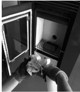
Figure 61 – Nettoyage de la vitre : a) appliquez du liquide sur le chiffon ; b) frottez la vitre avec le chiffon
