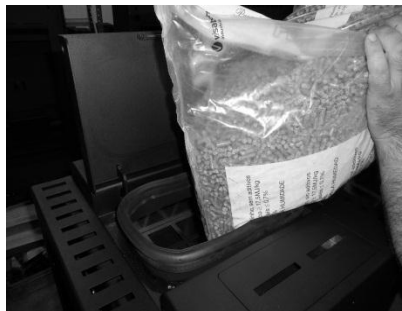
Figure 42 – Réapprovisionnement du réservoir à granulés
