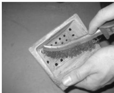
**Figura 78 – Pulizia del cestello di combustione**
