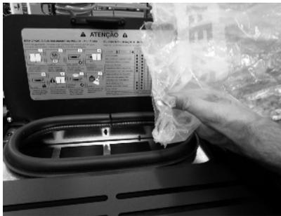
Figura 71 – Rifornimento del serbatoio pellet
