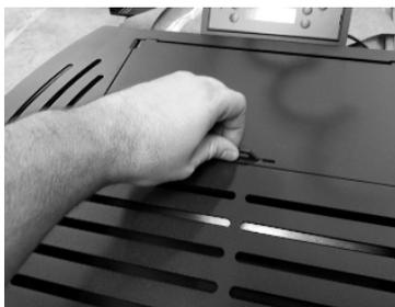
Figura 70 – Apertura del coperchio del serbatoio pellet
