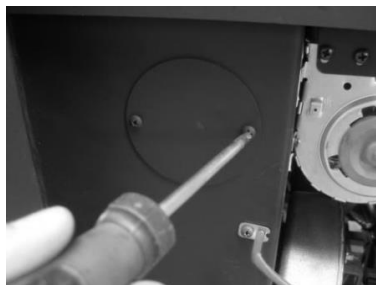
Figura 141 – Ejemplo K100 a) Retirar los tornillos; b) Retirar la tapa
