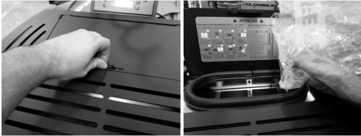
Figura 135 - Reabastecimiento del depósito de pellets
