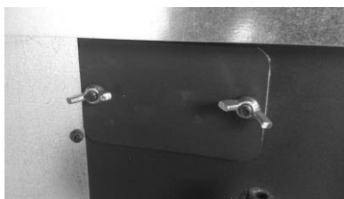
Figura 142 – Ejemplo K300, K400 y K500 a) Retirar las tuercas de mariposa; b) Retirar la tapa
