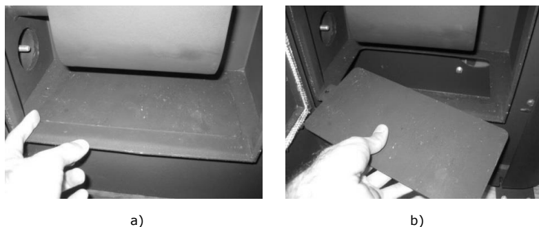
Figure 138 - Nettoyage de l'intérieur du poêle
