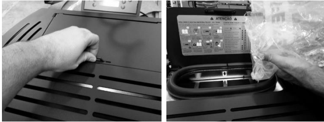
Figura 135 – Abastecimento do depósito de pellets
