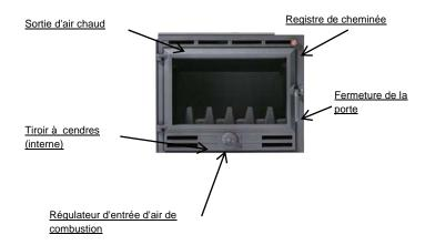
Fig. 1 – Identification des équipements Sahara et Flama.
