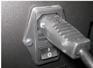
Imagen 32 – Enchufe de conexión a la corriente eléctrica
