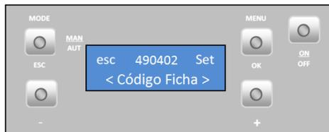
Le code logiciel / sécurité du firmware. En appuyant encore sur le bouton « + » on passe à « Código Display » (Code display).
