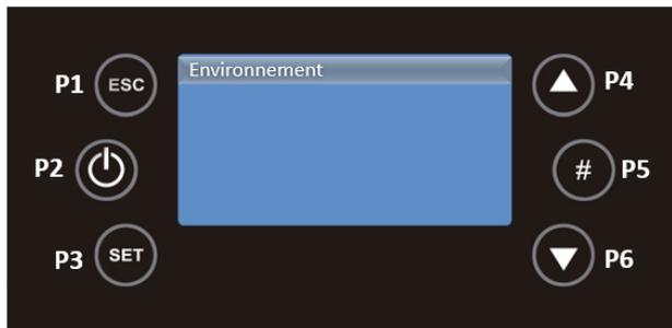
Vous pouvez régler la température cible de confort entre 10 et 40°C, à l'aide des touches P4 et P6.
