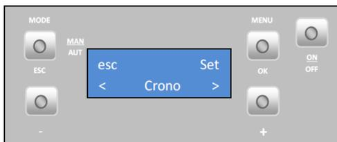
Les programmes peuvent être définis de deux manières différentes, à travers le menu "Carga Perfil" (charge du profil) ou à travers le programmeur journalier P1 à P6 (une seule option peut être active, elles ne fonctionnent pas simultanément). Appuyez sur la touche "+" pour accéder au menu "Carga Perfil".
