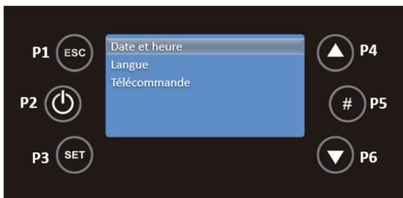
Dans le menu Date et Heure, sélectionnez Heure, avec les touches P4 et P6, et appuyez sur la touche P3, l'heure apparaîtra en mode modifiable, clignotante, avec P4 et P6 sélectionnez l'heure correcte et appuyez sur P3 pour valider.
