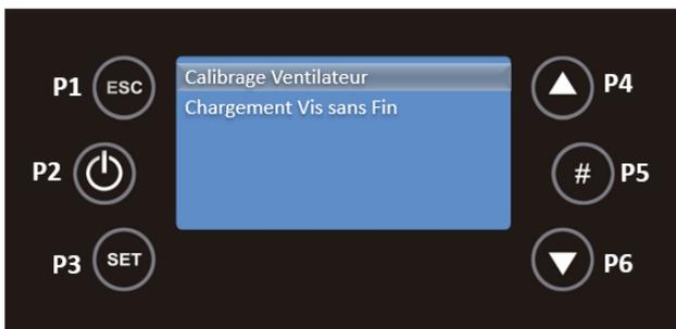
Dans ce sous-menu, les touches P4 et P6 permettent de régler la vitesse du ventilateur, entre -7 (-21%) et 7 (+21%). Pour revenir au menu Service, appuyez sur P1.
