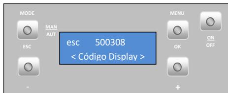
Code paramètres. En appuyant encore sur le bouton « + » on passe à « Horas de Funcionamento » (Heures de fonctionnement).
