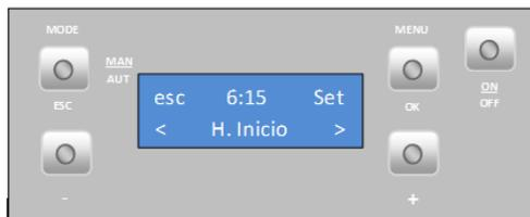
Pour entrer l'heure de fin du programme P1, appuyer sur « set » puis sur « + » ou « - » pour sélectionner (quart d'heure par quart d'heure), puis sur « ok » pour valider. Appuyer ensuite sur le bouton « + » pour passer au menu « P1 Temp. Ar ».
