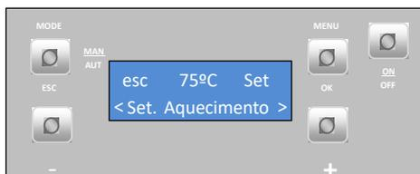
**Note** : dans l'équipement d'eau, la température de l'eau peut être réglée par l'utilisateur (température de set-point de l'eau) entre 50 et 80°C.
