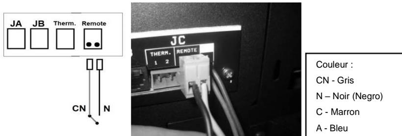
**Figure 41 - Connexion de la télécommande sans fil**
