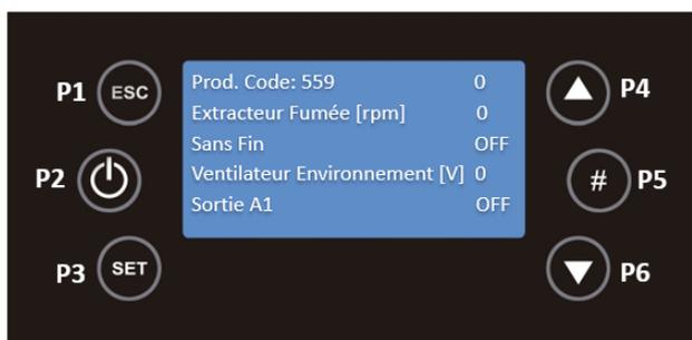
Il est possible d'interroger la température de la fumée, la température ambiante et l'état des entrées. Si l'état de l'entrée est ouvert (0) ou fermé (1).
