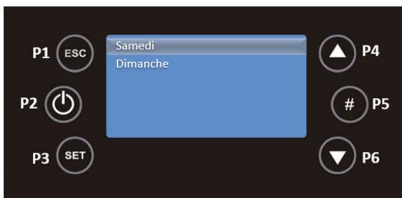
Vous devez appuyer sur P3 et ce champ sera en mode modifiable, clignotant. Appuyez sur P4 et P6 pour sélectionner l'heure souhaitée, puis utilisez la touche P3 pour enregistrer. Répétez ce processus pour la durée d'arrêt de l'unité, en utilisant P4 et P6. Enfin, activez l'intervalle en appuyant sur P5, et une coche apparaîtra à droite de l'intervalle.
