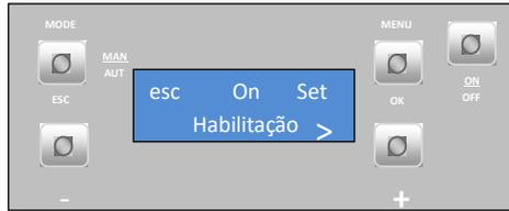
Pour entrer l'heure de démarrage du programme P1, appuyer sur « set » puis sur «+» ou «-» pour sélectionner (quart d'heure par quart d'heure), puis sur « ok » pour valider. Appuyer ensuite sur le bouton « + » pour passer au menu « P1 H. Stop ».
