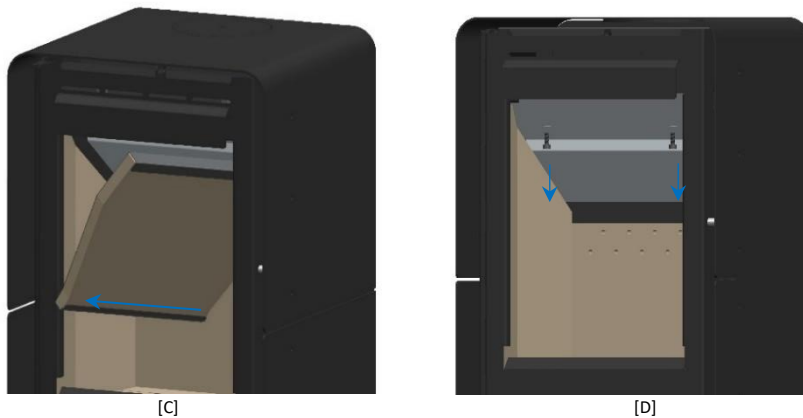
Figure 44 – Séquence à suivre pour retirer le déflecteur de fumée
