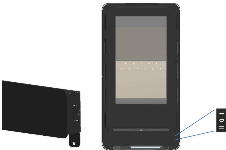
Figure 41 – Fixation de l'interrupteur sur le habillage avant
