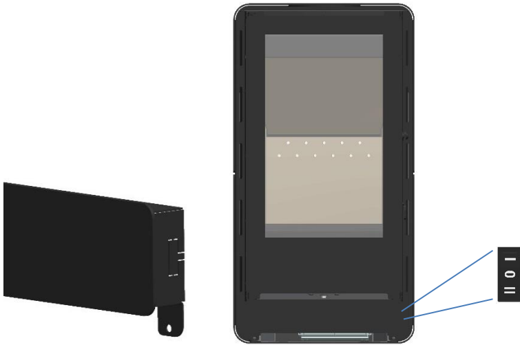
Figura 41 - Fijación del interruptor en la tapa frontal
