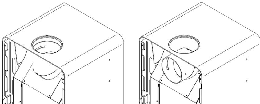
**Figura 17 - Reposicionar a saída de fumos**
