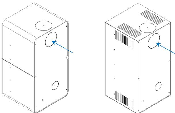
**Figura 15 - Secção a eliminar para converter a saída de fumos em modo horizontal**
