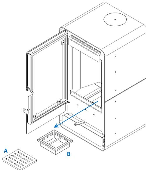
**Figura 53 - Remoção da gaveta de cinzas**
