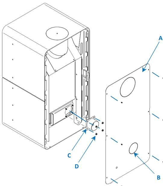
**Figura 33 - Secção a eliminar (B) para a colocação da entrada de ar externa (C)**
