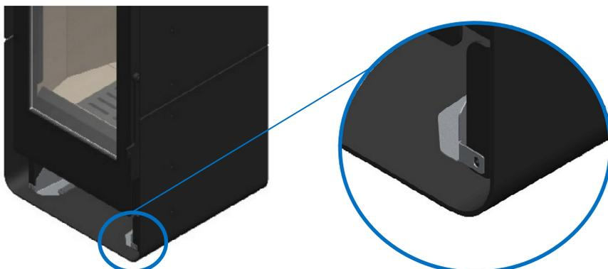
**Figura 49 - Fixação do kit de ventilação na salamandra Tek Round Eco**
