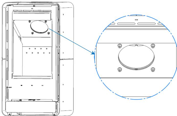
**Figura 16 - Parafusos de fixação da saída de fumos**
