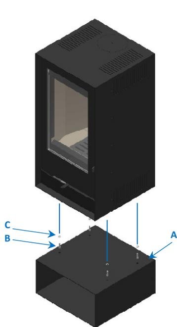
**Figura 19 - Fixação módulo lenheiro**
