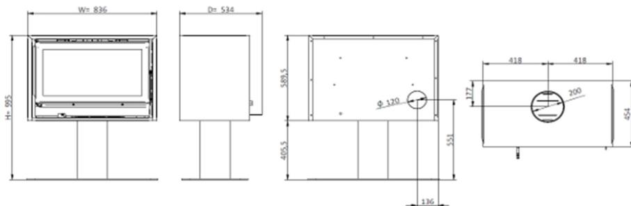
**Figura 10 - Dimensões gerais da salamandra a lenha Back Box Slim Eco**
