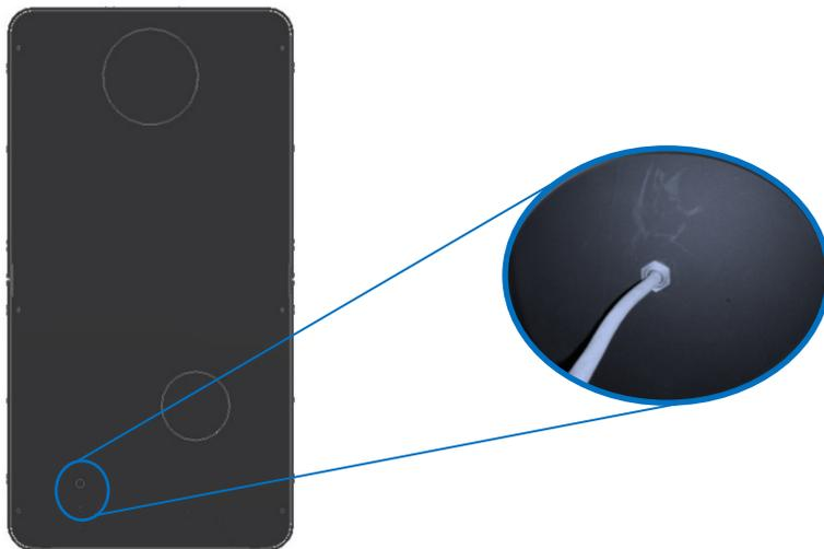
**Figura 48 - Passagem do cabo do kit de ventilação**
