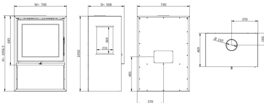
**Figura 12 - Dimensões gerais da salamandra a lenha Small Box Side Glass**
