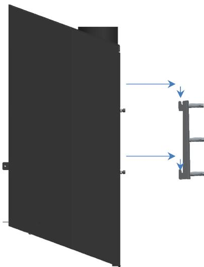
**Figura 23 - Posicionamento da salamandra nos apoios de parede**
