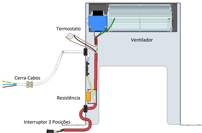
**Figura 45 - Kit de ventilação**
