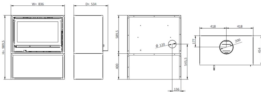
**Figura 9 - Dimensões gerais da salamandra a lenha Back Box Eco**
