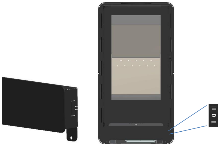
Figura 41 - Fissare Switch sul coperchio anteriore
