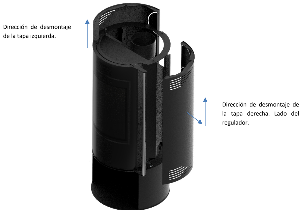
Figura 17 – Desmontaje de las tapas laterales del equipo
