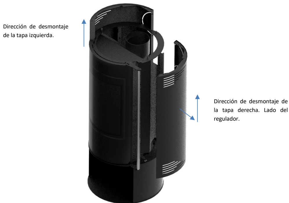
Figura 17 – Desmontaje de las tapas laterales del equipo
