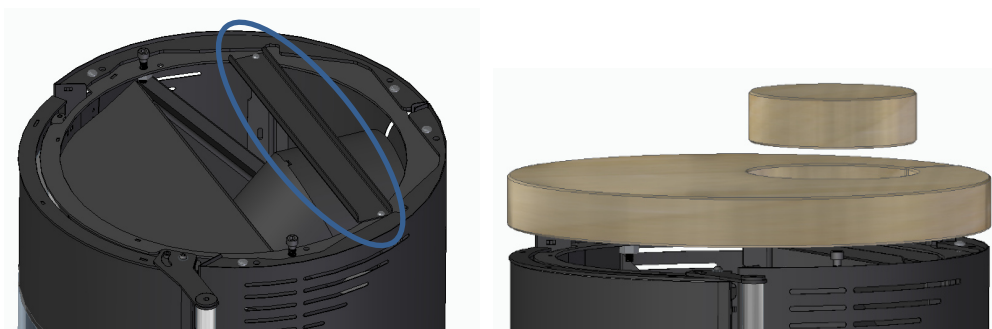
Figura 14 - Colocación de la tapa de piedra en el equipo con salida de humos horizontal
