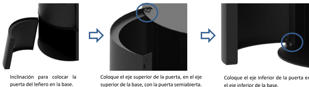
Figura 12 - Colocación de la puerta en la base/leñero del equipo
