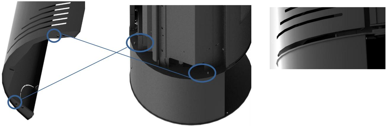
**Figure 18 - Centrage du couvercle latéral avec l'équipement**
