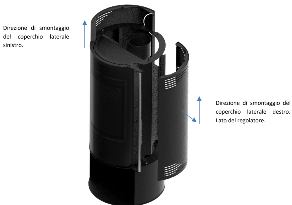
Figura 17 - Rimozione delle coperture laterali dell'unità
