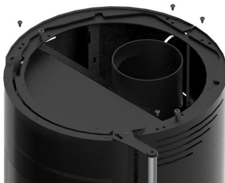
Figura 16 - Desmontagem das capas laterais no equipamento
