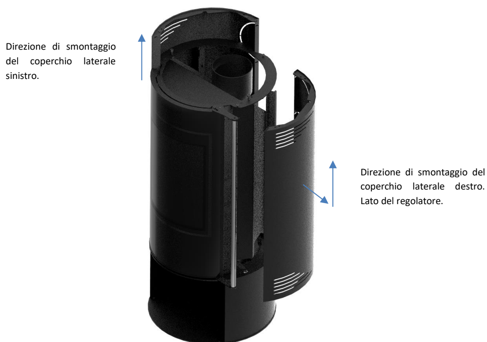
Figura 17 - Rimozione delle coperture laterali dell'unità
