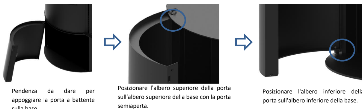
Figura 12 - Posizionamento della porta sulla base/piantone dell'apparecchiatura
