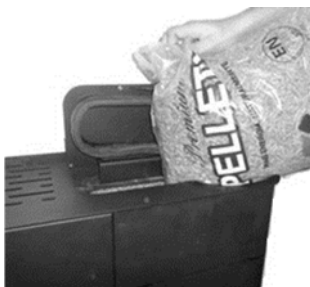
Figura 113 - Reabastecimiento del depósito de pellets
