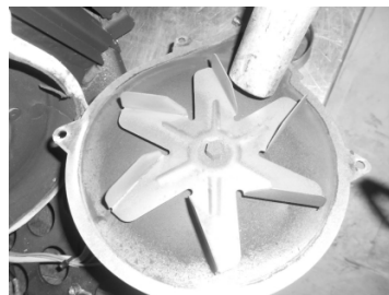
Figura 129 - a) Aspirar la concha del extractor; b) Aspirar el extractor
