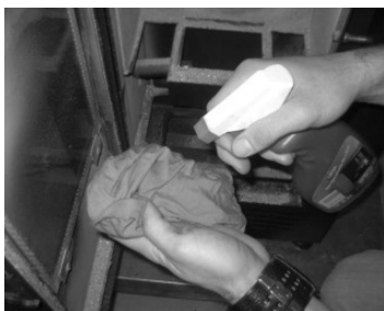
Figura 115 - Limpieza del vidrio: a) aplicar líquido en el paño; b) limpiar el vidrio con el paño
