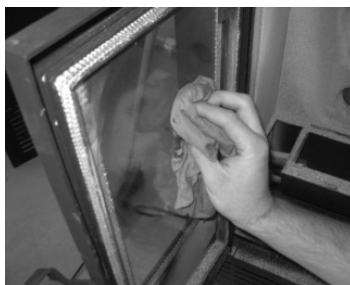
Figura 115 - Limpieza del vidrio: a) aplicar líquido en el paño; b) limpiar el vidrio con el paño
