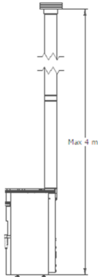
Figura 26 – Ejemplo de una instalación de tipo A
