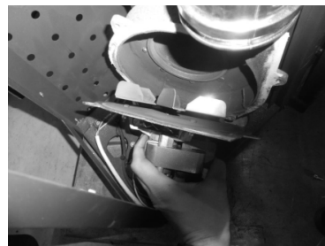
Figura 128 - a) Retirar los tornillos; b) Retirar el extractor
