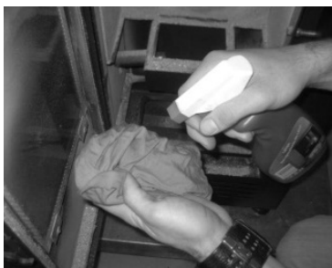
Figure 115 – Nettoyage vitre a) appliquer liquide ; b) nettoyage avec chiffon
