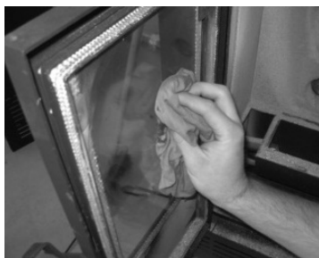
Figure 115 – Nettoyage vitre a) appliquer liquide ; b) nettoyage avec chiffon
