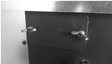
Figure 140 – Exemple K300, K400 et K500 a) Enlever les écrous à oreilles ; b) Retirer le couvercle
