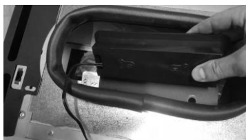
Figura 15 - Display dentro del tanque de pellets
