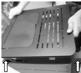
Figura 14 - Desmontaje de la tapa superior
