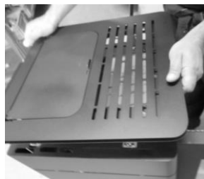
a) Desmontaje de la tapa superior
