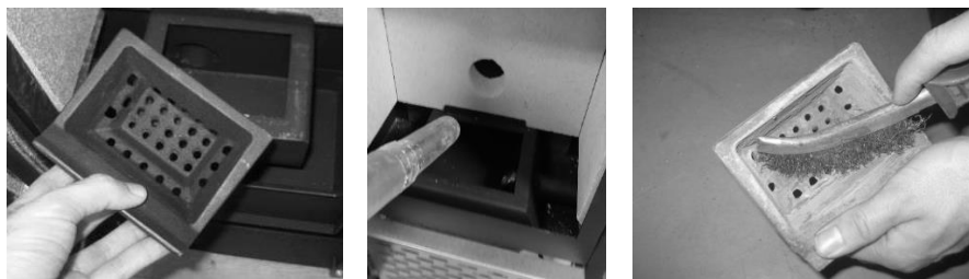
a) Cestillo de quema b) Limpieza del interior c) Limpieza cestillo de quema
