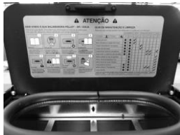
Figura 18 - Etiqueta con las tareas de mantenimiento
