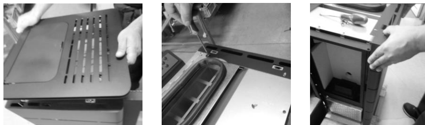
a) Desmontaje de la tapa superior b) Desmontaje de los tornillos c) Desmontaje de las tapas laterales
