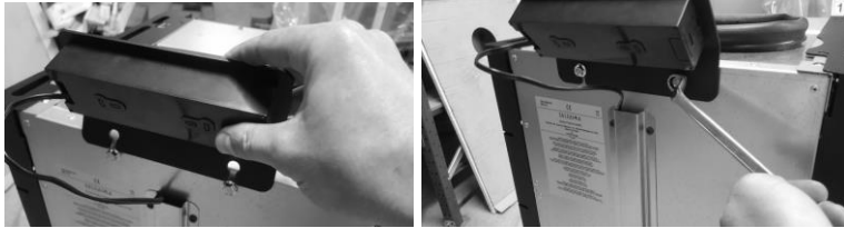
Figura 16 - Fijación del display
