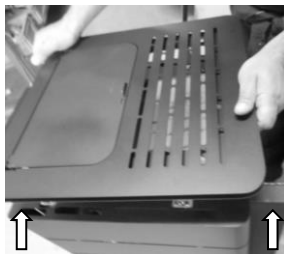
Figura 14 - Desmontaje de la tapa superior
