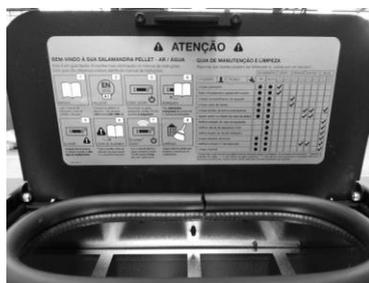
**Figure 19 – Étiquette avec les tâches d'entretien**
