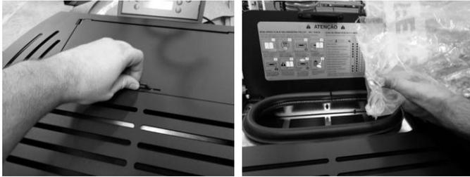
**Figura 18 – Abastecimento do deposito de pellets**
