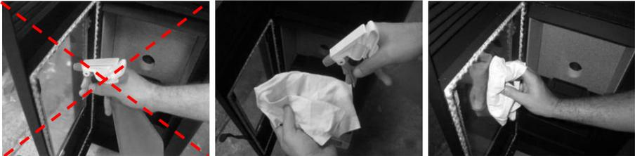
a) Nettoyage incorrect de la vitre b) ) appliquez du liquide sur le chiffon c) nettoyez la vitre avec le chiffon
