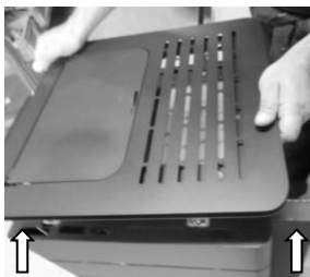
Figure 15 – Enlèvement du couvercle
