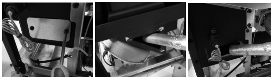
a) Retrait pièce latérale b) Aspiration frontale c) Aspiration latérale
