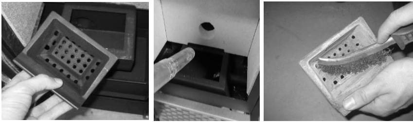
a) Retrait du creuset b) Nettoyage intérieur c) Nettoyage creuset
