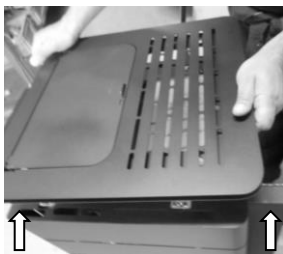
Figure 15 – Enlèvement du couvercle
