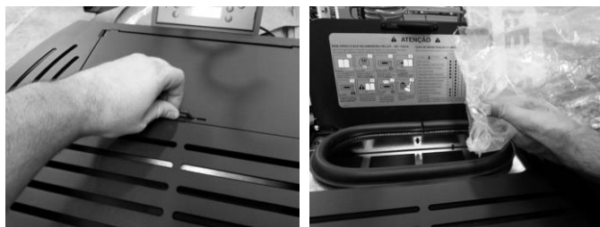
Figura 18 – Abastecimento do deposito de pellets
