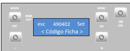
Code du logiciel / microprogramme de sécurité. Appuyez sur la touche « + » pour accéder au menu suivant « código Display » (code afficheur).
