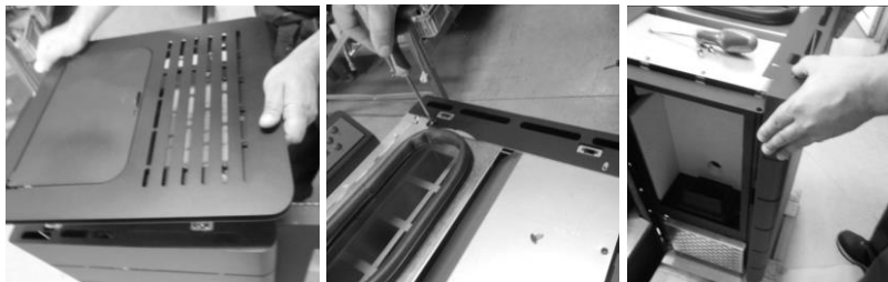
Figure 22 – Retrait du couvercle supérieur et latéral
