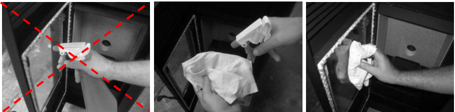
Figure 20 – nettoyage de la vitre
