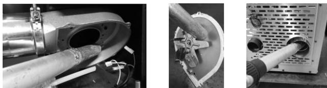
a) Nettoyage carter      b) Nettoyage turbine      c) Nettoyage tube de sortie
