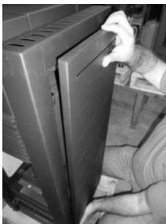
Figura 11 - Montaggio delle cappe laterali
