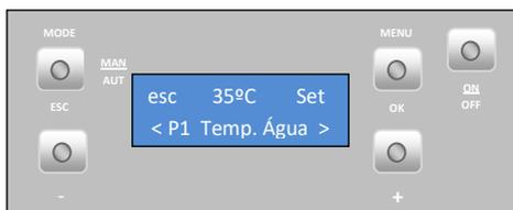
Per impostare la **temperatura di funzionamento** (da 1 a 5) nel programma P1, premere "set" e, appena inizierà a lampeggiare, premere il tasto "+" o "-" per selezionare la temperatura, quindi premere "ok" per confermare il dato. Premere il tasto "+" per passare al menù "P1 Dia" (P1 Giorno).
