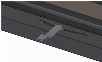
En la posición totalmente a la izquierda tanto la entrada de aire primario como secundario están cerradas, tan solo se permite un pequeño paso de aire de secundario por seguridad, para evitar posibles concentraciones de gases.
