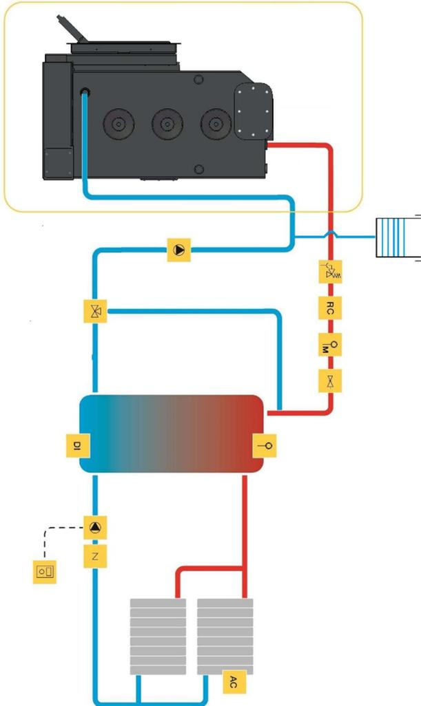
Nota: en el caso de instalar el vaso expansión cerrado colocar en su lugar la válvula de descarga de presión y temperatura.
