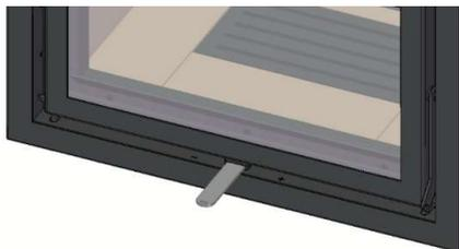
En los modelos Mytho Eco PV, Acqua Eco PV el útil se inserta en el orificio verticalmente, tal y como se aprecia en las siguientes imágenes.
