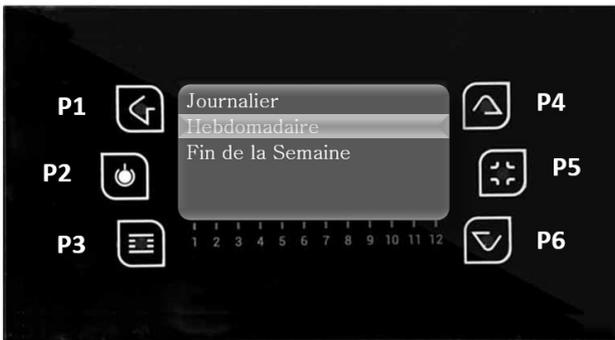
Vous devez appuyer sur P3 et ce champ sera en mode modifiable, clignotant. Appuyez sur P4 et P6 pour sélectionner l'heure souhaitée, puis utilisez la touche P3 pour enregistrer. Répétez ce processus pour la durée d'arrêt de l'unité, en utilisant P4 et P6. Enfin, activez l'intervalle en appuyant sur P5, et une coche apparaîtra à droite de l'intervalle.
