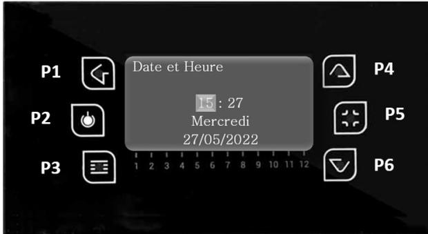
La même chose doit être faite pour les minutes, avec P6 sélectionnez Minutes et appuyez sur P3, les minutes apparaîtront en mode modifiable, clignotant, avec P4 et P6 sélectionnez les bonnes minutes et appuyez sur P3 pour valider.
