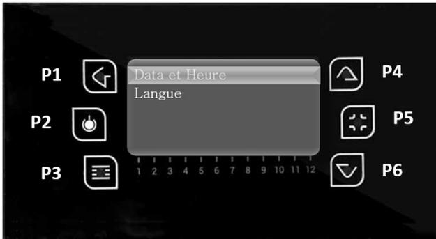
Dans le menu Date et Heure, sélectionnez Heure, avec les touches P4 et P6, et appuyez sur la touche P3, l'heure apparaîtra en mode modifiable, clignotante, avec P4 et P6 sélectionnez l'heure correcte et appuyez sur P3 pour valider.
