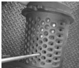
Figure 51 – Nettoyage du brûleur et la plaque de nettoyage
