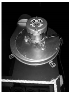
Figure 53 – Enlevez les vis de l'extracteur et aspirez la zone de passage d'air
