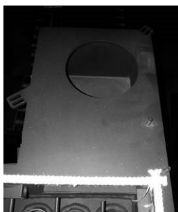
Figure 53 – Enlevez les vis de l'extracteur et aspirez la zone de passage d'air
