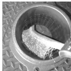
Figure 51 – Nettoyage du brûleur et la plaque de nettoyage
