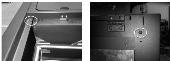
Figura 59– Rimuovere le viti del coperchio superiore, sulla parte anteriore e posteriore della caldaia, per accedere all'estrattore
