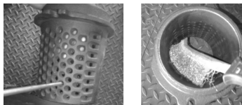
Figura 58 - Pulizia del bruciatore e piastra pulizia.
