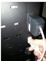
Figura 24 – Collegamento dei sensori alla scheda elettronica
