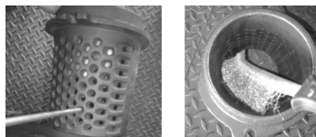
Figura 56 - Pulizia del bruciatore e piastra pulizia.
