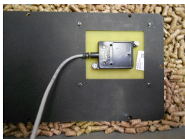
Figura 26 – Posizionamento dei sensori sul pellet
