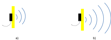
Figura 22 – Differenza tra sensore di livello a bassa sensibilità (a) e ad alta sensibilità (b)
