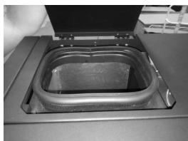
Figura 16 – Rifornamento del serbatoio pellet
