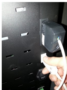
Figura 41 – Ligação do motor do silo e dos sensores à placa eletrónica
