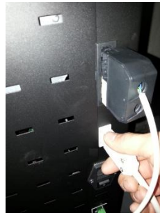
Figura 41 – Conexión del sensor a la placa electrónica
