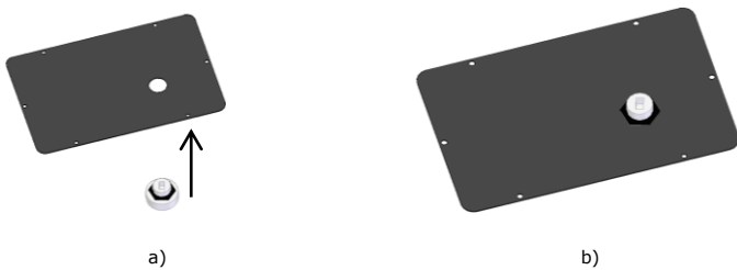
Figura 37 – Fijación del sensor de nivel en la pieza
