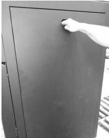
Figura 14 - Retirada de las tapas laterales
