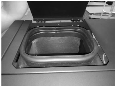
Figura 16 - Reabastecimiento del depósito de pellets
