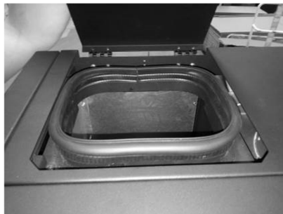
Figura 16 - Reabastecimiento del depósito de pellets
