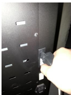
Figura 48 – Collegamento del motore del silo e dei sensori alla scheda elettronica
