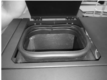
Figura 16 – Rifornamento del serbatoio pellet
