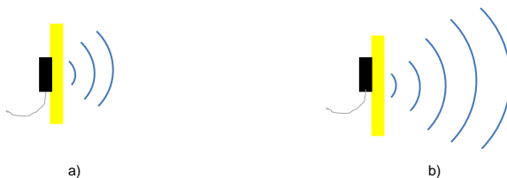
Figura 22 – Differenza tra sensore di livello a bassa sensibilità (a) e ad alta sensibilità (b)
