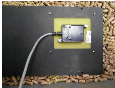
Figura 26 – Posizionamento dei sensori sul pellet
