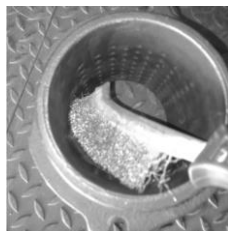
Figura 58 - Pulizia del bruciatore e piastra pulizia.
