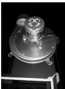
Figura 60 – Togliere le viti dall'estrattore e aspirare la zona di passaggio dell'aria
