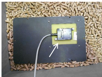
Figura 27 – Regolazione della sensibilità dei sensori
