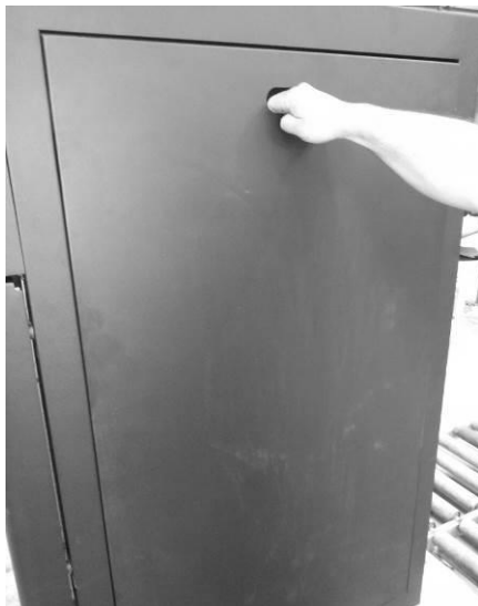
Figura 14 – Rimozione dei mantelli laterali
