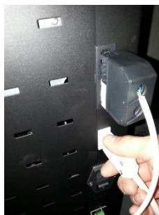
Figura 24 – Collegamento dei sensori alla scheda elettronica
