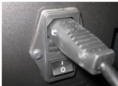
Figura 8 – Spina di alimentazione elettrica.
