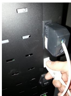
Figura 48 – Collegamento del motore del silo e dei sensori alla scheda elettronica
