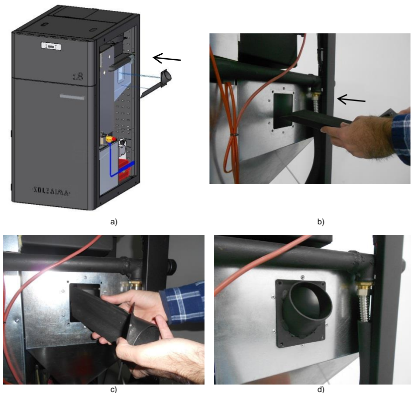
Figura 31 – Montaggio della rampa per la caduta del pellet
