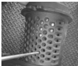
Figura 58 - Pulizia del bruciatore e piastra pulizia.
