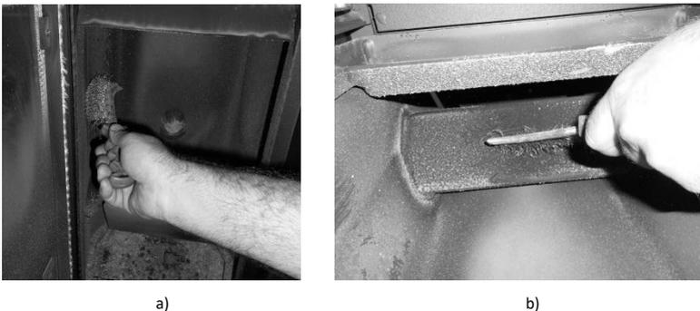
**Figura 25 - Limpieza de interiores de la estufa agua**
