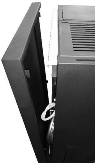
Figura 15– retirada de las tapas laterales
