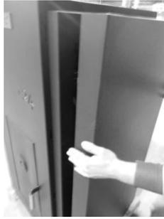
Figure 13 – Enlèvement des panneaux latéraux
