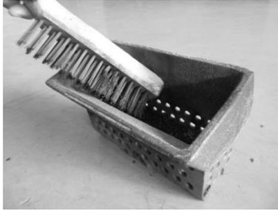
Figure 25 – Nettoyage du panier de combustion
