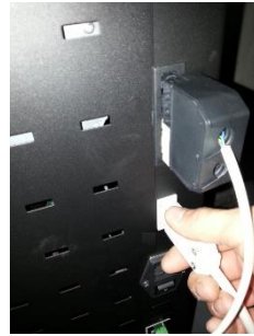
Figura 21 – Conexión del sensor a la placa electrónica
