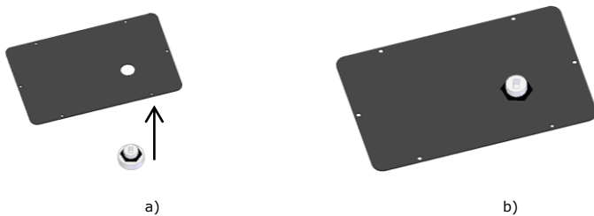
Figura 17 – Fijación del sensor de nivel en la pieza
