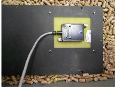
Figure 6 – Installation des capteurs au-dessus des granulés
