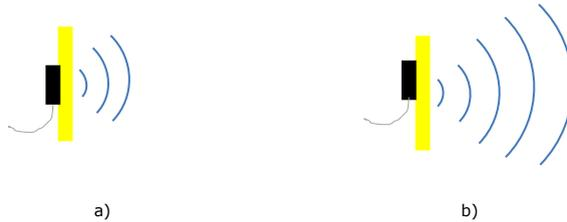
Figure 2 – Différence entre le capteur de niveau à faible sensibilité (a) et à haute sensibilité (b)
