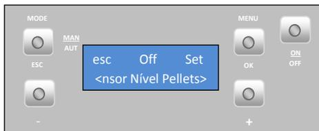
Lorsque le silo reste sans granulés, le capteur émet un signal et une alarme apparaît sur l'afficheur de la chaudière (code A15). Remplissez le silo avec des granulés, acquittez l'alarme (*reset*) et initiez à nouveau la chaudière.
