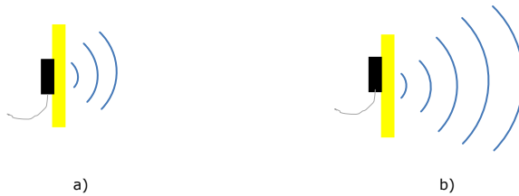
Figura 2 - Differenza tra sensore di livello a bassa sensibilità (a) e ad alta sensibilità (b)
