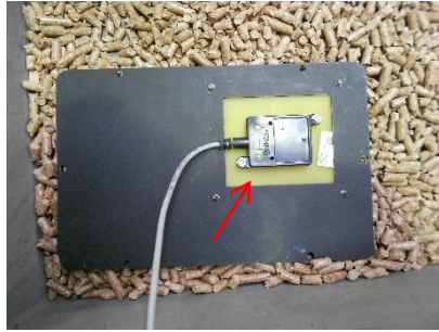
Figura 7 – Regolazione della sensibilità dei sensori
