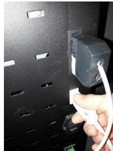
Figura 28 - Collegamento del motore del silo e dei sensori alla scheda elettronica
