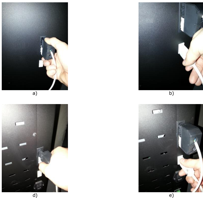
Figura 4 – Collegamento dei sensori alla scheda elettronica
