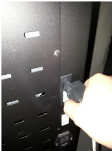
Figura 28 - Collegamento del motore del silo e dei sensori alla scheda elettronica
