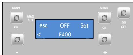
Quando o silo ficar sem pellets, o sensor emite um sinal e surge um alarme no display da caldeira (código A15). Deverá encher o silo com pellets, fazer *reset* ao alarme e reiniciar a caldeira.
