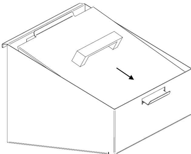
**Figura 34 - Remoção da gaveta de cinzas do queimador**
