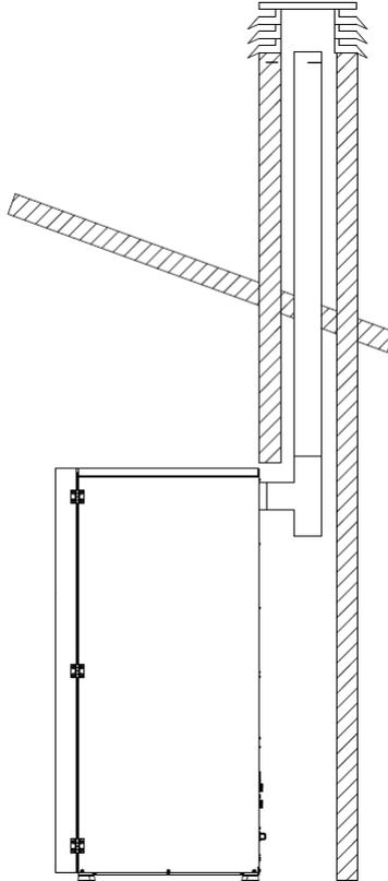
**Figura 21 - Vista lateral da instalação com chaminé**
