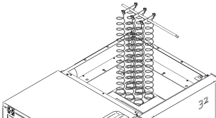
**Figura 43 - Retirar sistema de molas de limpeza**
