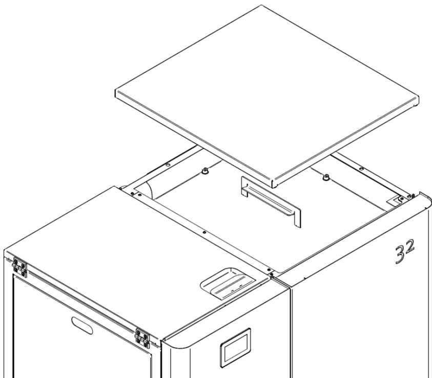
**Figura 40 - Remoção da tampa superior exterior**
