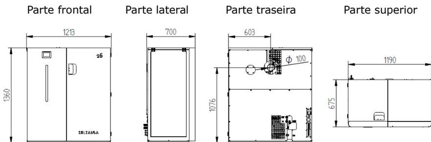
**Figura 3 C - Dimensões gerais caldeira SZM A PLUS 16 kW (NS≥01-25-00082)**
