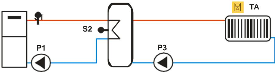
Figura 51 - Ligação a radiadores de aquecimento central em conjunto com outra caldeira, acumuladores, água quente sanitária e em combinação com painel solar
