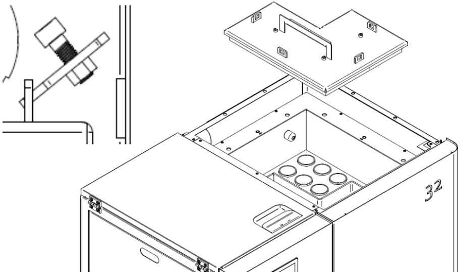
**Figura 45 - Remoção da tampa interior**
