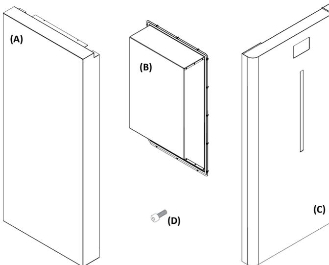
**Figura 9 - Componentes do kit de extensão do silo**
