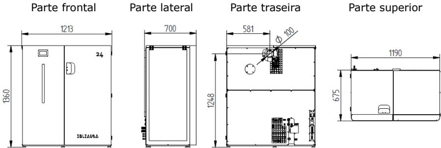
**Figura 3 D - Dimensões gerais caldeira SZM A PLUS 24 kW (NS≥01-25-00102)**
