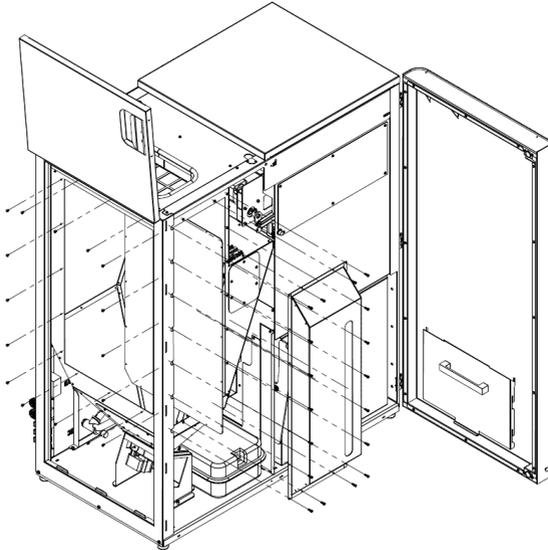
**Figura 12 - Remoção dos parafusos da lateral e do frontal do silo**
