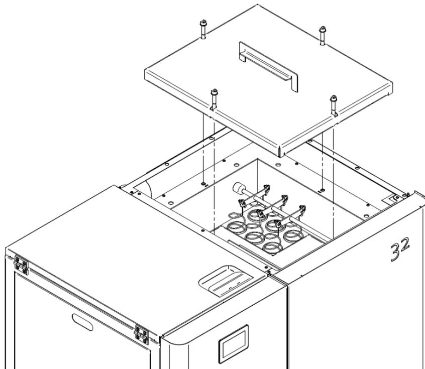
**Figura 41 - Remoção da tampa superior do corpo**
