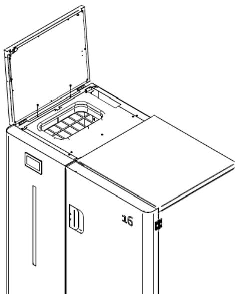
**Figura 10 - Remoção dos parafusos que fixam a lateral da caldeira**
