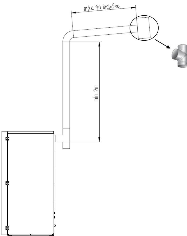
**Figura 20 - Exemplo de instalação de conduta de fumos C**
