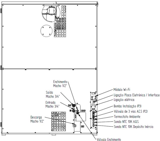
**Figura 5 - Ligações caldeiras a pellets SZM A PLUS 16 (NS≥01-25-00082), 24 (NS≥01-25-00102) e 32 kW**
