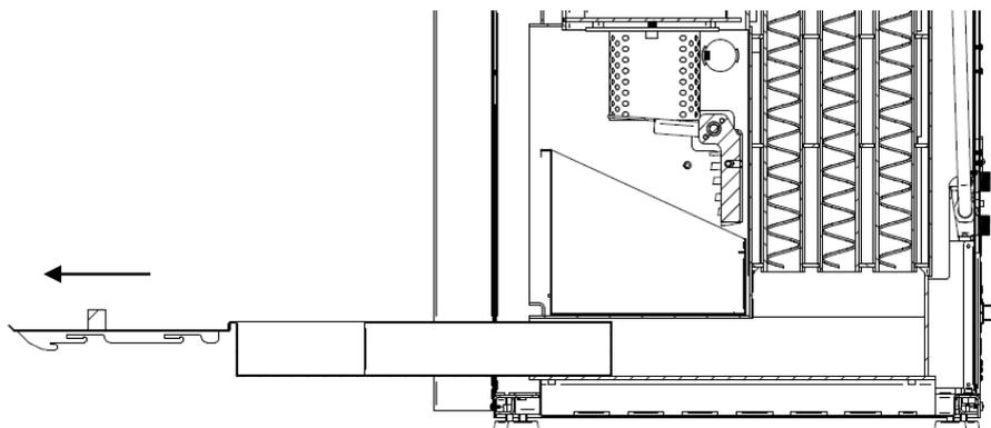
**Figura 36 - Remoção da gaveta de cinzas dos turbuladores**
