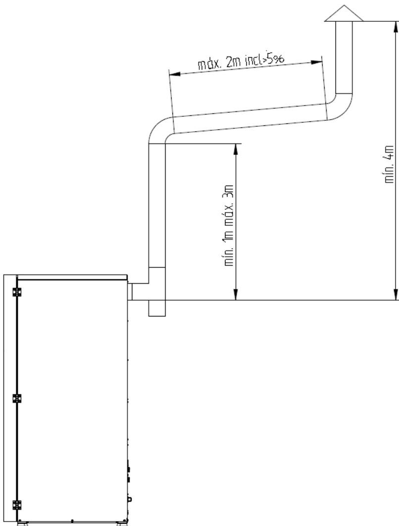
**Figura 19 - Exemplo de instalação de conduta de fumos B**
