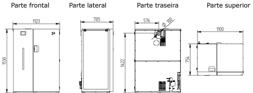
**Figura 3 E - Dimensões gerais caldeira SZM A PLUS 32 kW**
