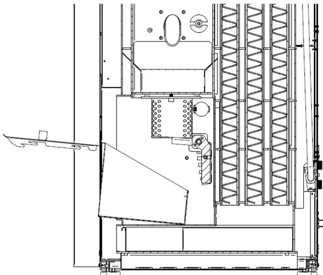
**Figura 33 - Remoção da gaveta de cinzas do queimador**
