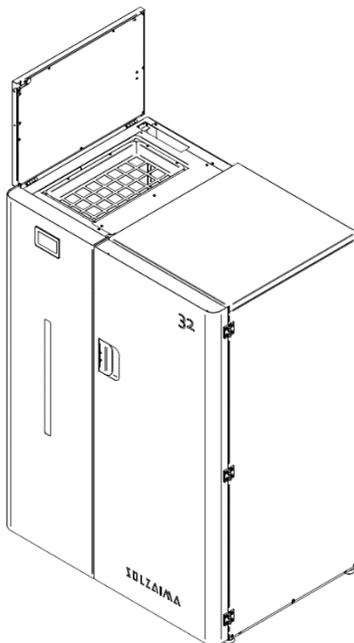
**Figura 29 - Reabastecimento do depósito de *pellets***
