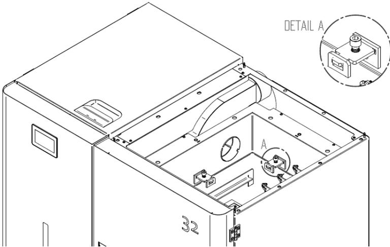
**Figura 44 - Remoção da tampa interior**
