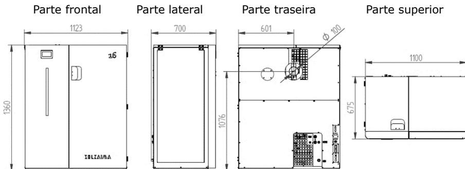
**Figura 3 A - Dimensões gerais caldeira SZM A PLUS 16 kW (NS≤01-25-00081)**
