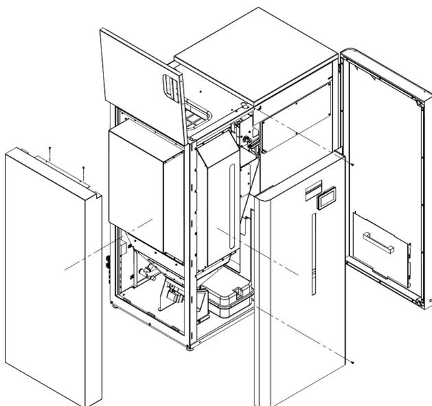
**Figura 15 - Aplicação do lateral e do frontal do equipamento**
