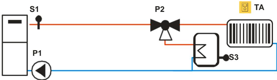
**Figura 50 – Ligação a radiadores de aquecimento central e água quente sanitária**
