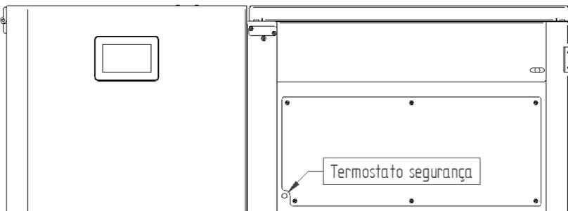
**Figura 28 - Termostato de segurança de temperatura**
