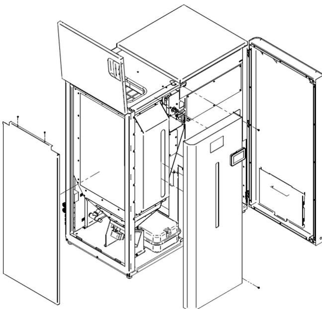
**Figura 11 - Remoção dos parafusos que fixam o frontal da caldeira**
