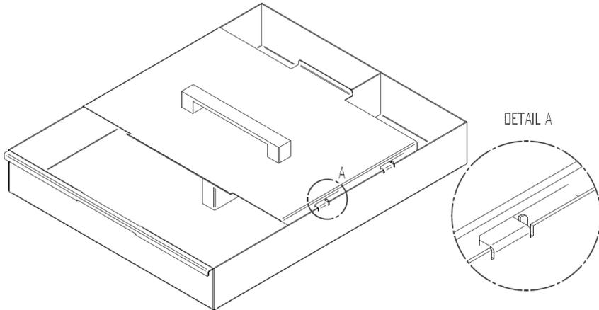
**Figura 37 - Remoção da gaveta de cinzas dos turbuladores**
