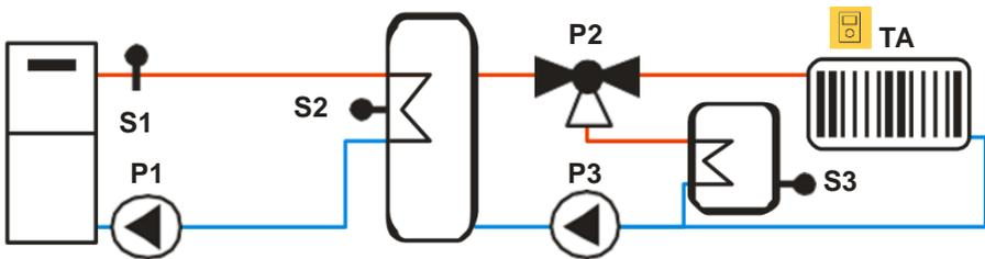
Figura 52 - Ligação de aquecimento por piso radiante, em conjunto com outra caldeira, água quente sanitária e combinação com painel solar
