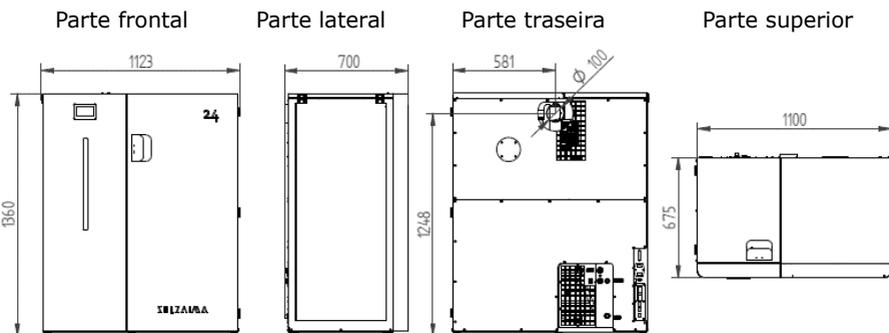
**Figura 3 B - Dimensões gerais caldeira SZM A PLUS 24 kW (NS≤01-25-00101)**
