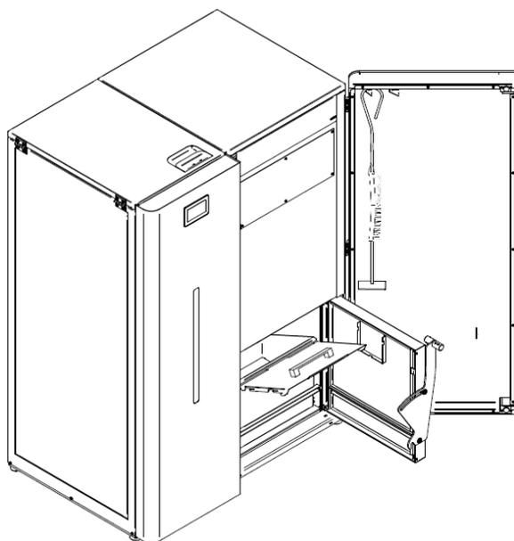
**Figura 31 - Remoção da gaveta de cinzas do queimador**
