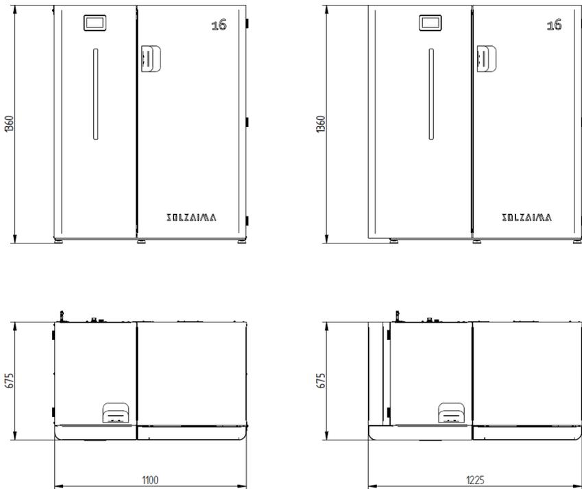
**Figura 16 - Dimensões da caldeira com e sem kit de extensão do silo**
