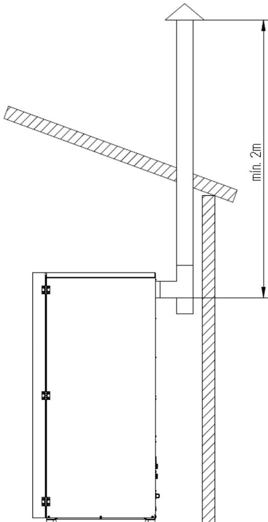
**Figura 18 - Exemplo de instalação de conduta de fumos A**
