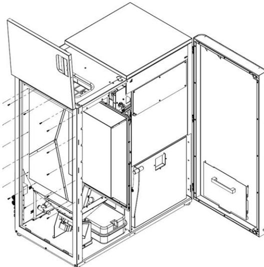
**Figura 13 - Aplicação do novo lateral do silo**
