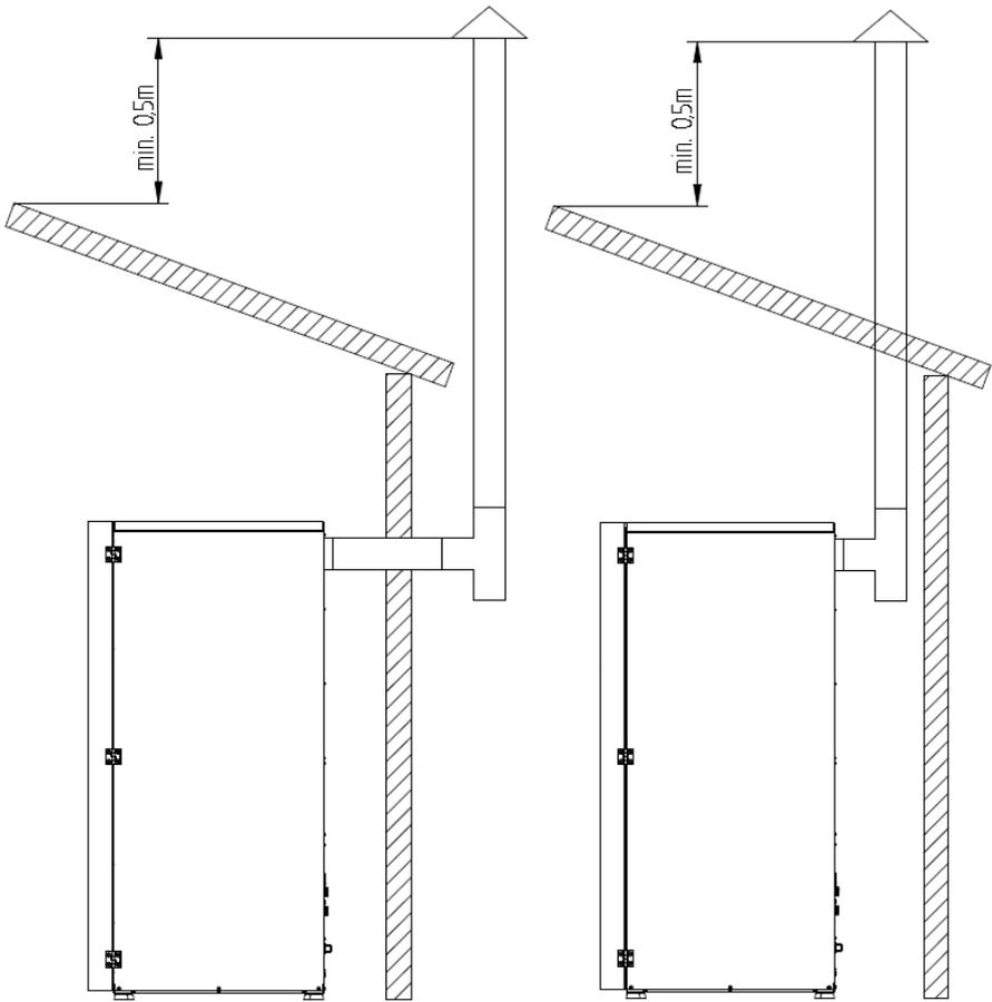
**Figura 17 - Vista lateral da instalação sem chaminé**
