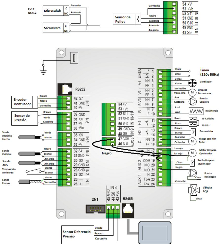
Figura 53 - Esquema eléctrico
