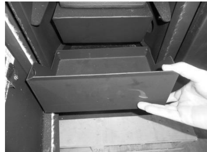
Figura 30 - a) Cestillo de quema; b) Cestillo de cenizas
