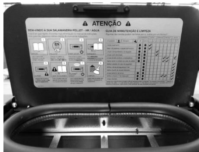
Figura 23 - Etiqueta con las tareas de mantenimiento
