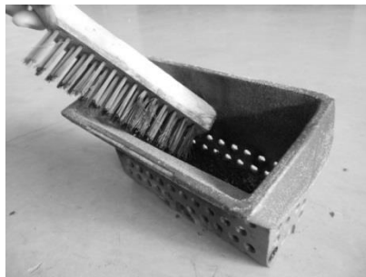
Figure 31 - Nettoyage du panier de combustion
