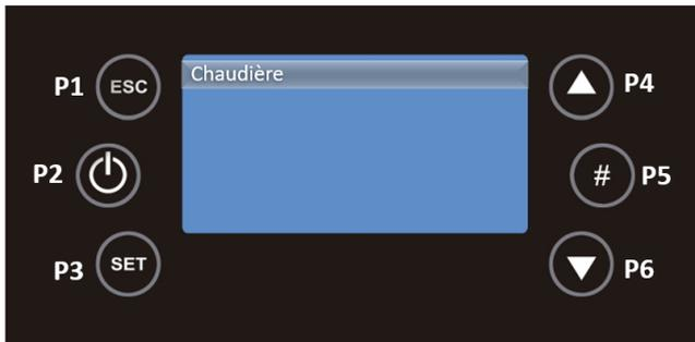
Ce sous-menu permet de modifier la valeur du thermostat de la compacte, à l'aide des touches P4 et P6. Les valeurs minimales et maximales peuvent être définies.
