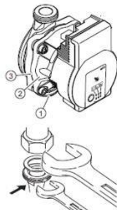
Figure 50 – L'installation de la pompe
