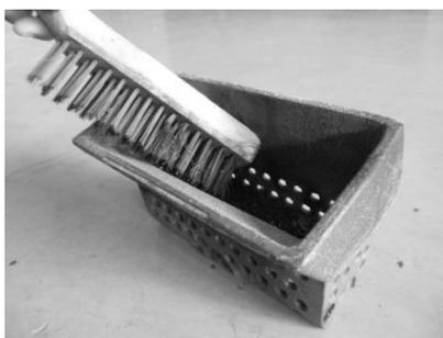
**Figure 31 - Nettoyage du panier de combustion**
