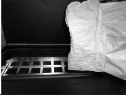
Figure 18 - Réapprovisionnement du réservoir à granulés
