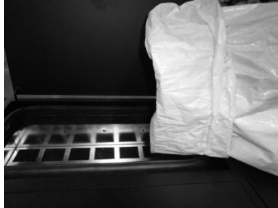
Figura 18 - Reabastecimiento del depósito de pellets
