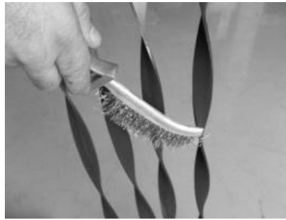
Figura 33 - Limpeza dos canais de passagem de ar e turbuladores
