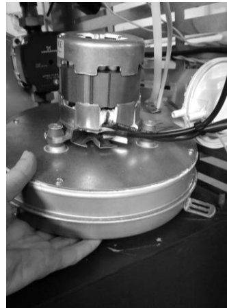
Figura 34 - a) Retirar os parafusos; b) Retirar extractor
