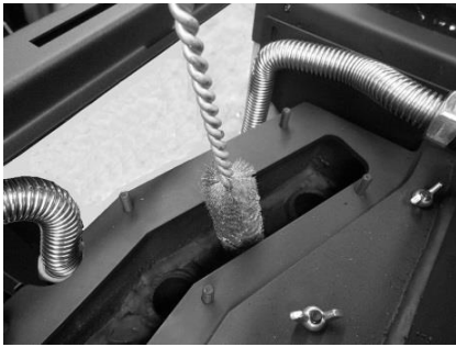
Figura 33 - Limpeza dos canais de passagem de ar e turbuladores
