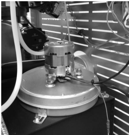
Figura 34 - a) Retirar os parafusos; b) Retirar extractor
