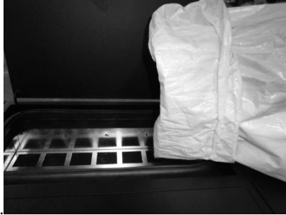
Figura 18 - Reabastecimento do depósito de pellets
