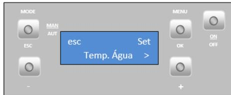
Pour régler la **température de chauffage** souhaitée, en appuyant sur les bouffées « SET »; appuyez sur la « + » ou « - » pour sélectionner la valeur souhaitée, appuyez sur « ok » pour confirmer la valeur. Appuyez sur la touche « esc » pour sortir.
