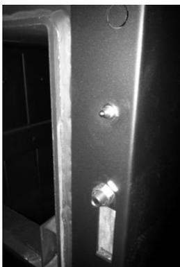
**Figura 2 - Microinterruttore posto sul fronte della caldaia**
