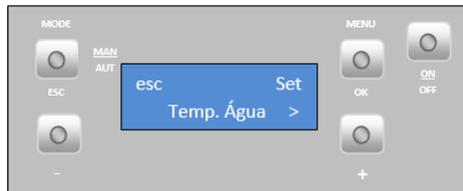
Per configurare la temperatura di riscaldamento desiderata, premendo "SET" lampeggia; premere il tasto "+" o - per selezionare il valore desiderato, premere "OK" per confermare il valore "". Premere il tasto "ESC" per uscire.
