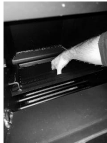
Figure 16 - Nettoyage de la chambre de combustion
