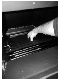
Figura 16 - Limpieza de la cámara de combustión
