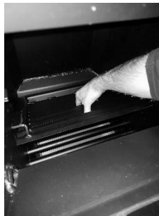
Figura 16 - Limpeza da câmara de combustão
