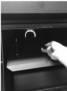
Figura 16 - Limpieza de la cámara de combustión
