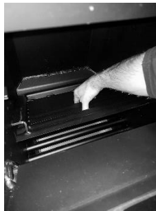
Figura 16 - Limpieza de la cámara de combustión
