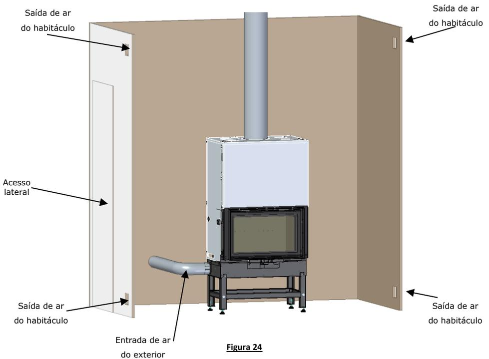
É importante assegurar que os tubos das condutas não estão em contacto com a o tubo de saída de gases ou o tubo de carga de *pellets* para evitar ruídos ou vibrações durante o funcionamento do inserível. Na Figura 25 é ilustrado o exemplo de uma instalação com as entradas e saídas de ar do equipamento.
